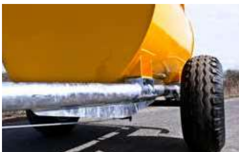
Forsterket galvanisert rør i stål for ekstra hardfør- og holdbarhet
