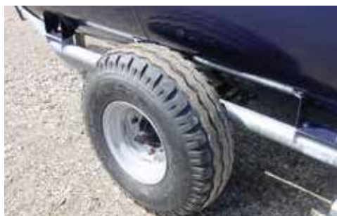
Flotasjonsdekk for ulent terreng
